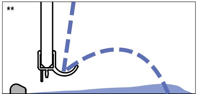
Die spezielle waagerechte Dichtleiste mit Wasserabpralleffekt lässt im Gegensatz zu herkömmlichen Dichtleisten schnell ablaufendes Wasser mit Abstand zum Türflügel aufprallen. So gelangt deutlich weniger Spritzwasser ins Freie.
