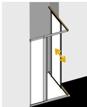
z.B.: NOVA 2000 Eckeinstieg - Halbtteil ohne Festfeldglas mit durchgehender oberer und unterer Führungsschiene.
